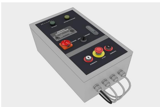
Блок управления — корпус стальной окрашенный 300 x 400 x 150 мм; класс защиты — IP54; с частотным преобразователем
